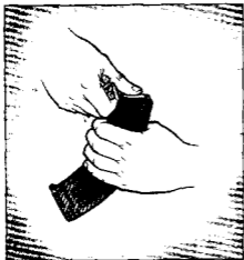
Рис. 33. Снаряжение магазина патронами
