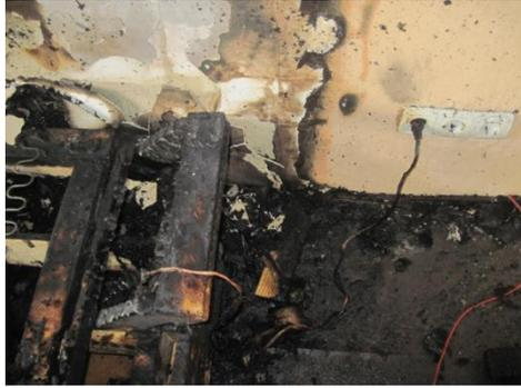
возникновению пожара. Недостаточный (слабый контакт) соединений в распределительных коробках, розетках или автоматических выключателей может привести к их нагреву и, соответственно, возгоранию. Если контакты ослабли, то в месте соединения сопротивление растёт. Из-за этого провода (или монтажные пластины) начинают греться, а изоляция плавиться.
